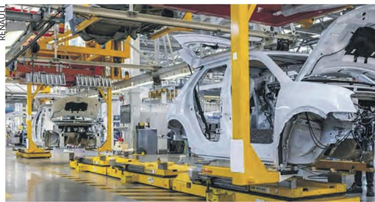
Fabrication des prototypes de la future Renault 5 électrique.
