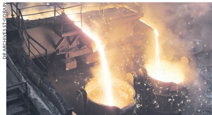
Coulée du haut-fourneau en 2014 à Saint-Gobain PAM.
